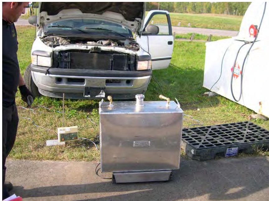
Figure 3. Installation et pesage des réservoirs temporaires.
